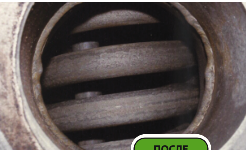
Устранение с мешанного оксида железа со змеевика
