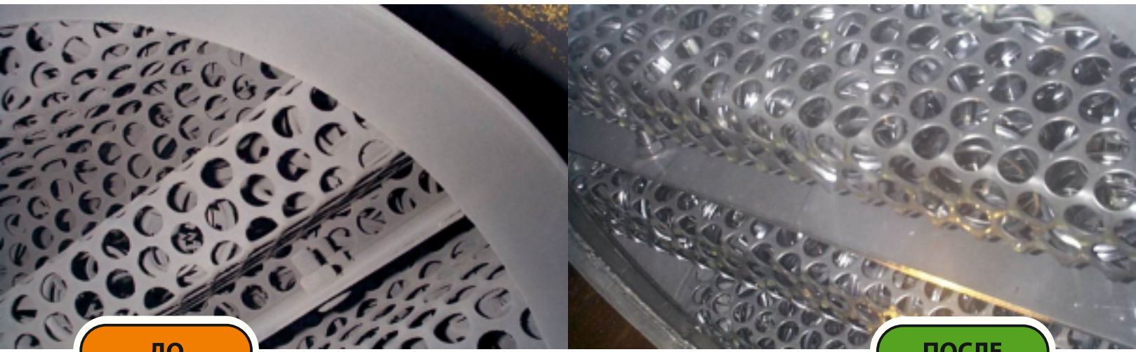
Устранение смешанного органического и неорганического загрязнения за один заход с регенератор
