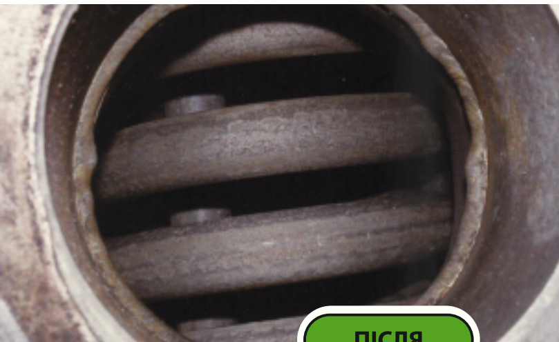
Усунення з мішаного оксиду заліза зі змійовика
